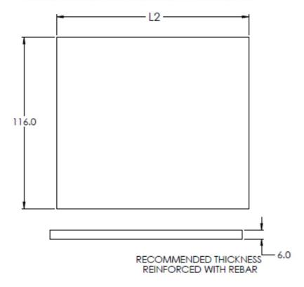
RECOMMENDED SPACING BETWEEN AXLE PAD DECKS: 46.5"
